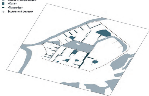
Schéma | Une trame bleue résiliante qui améliore les capacités de ressuyage du site
