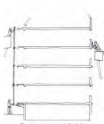
MISE EN PLACE DE LA STRUCTURE MÉTALLIQUE SUSPENDUE
