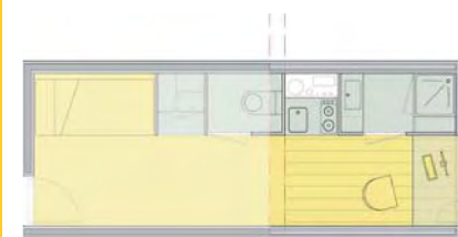
PLAN D'UNE CHAMBRE AVEC GAINES AJOUTEE (VARIANTE)
