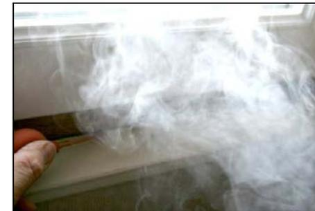
**Figure 2 : test d'infiltration avec poire à fumée (Espace Énergie)**
