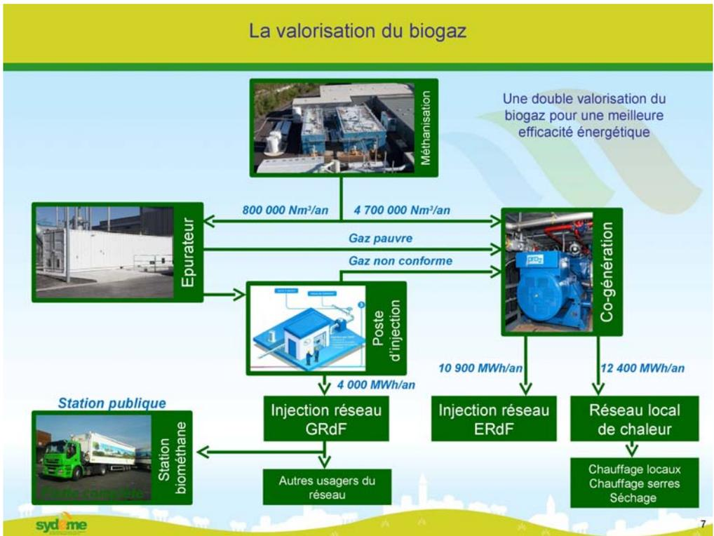
Nous avons mis en place cette double valorisation du biogaz sur notre site d'abord pour des raisons historiques. Quand la cogénération a été lancée, il n'était plus possible de revenir en arrière, et nous avons plutôt complété par l'injection dans le réseau, ce que nous comptons d'ailleurs renforcer cette année en doublant la capacité. Nous en sommes maintenant à une capacité d'à peu près 4 000 MWh par an, et nous aimerions bien doubler.
