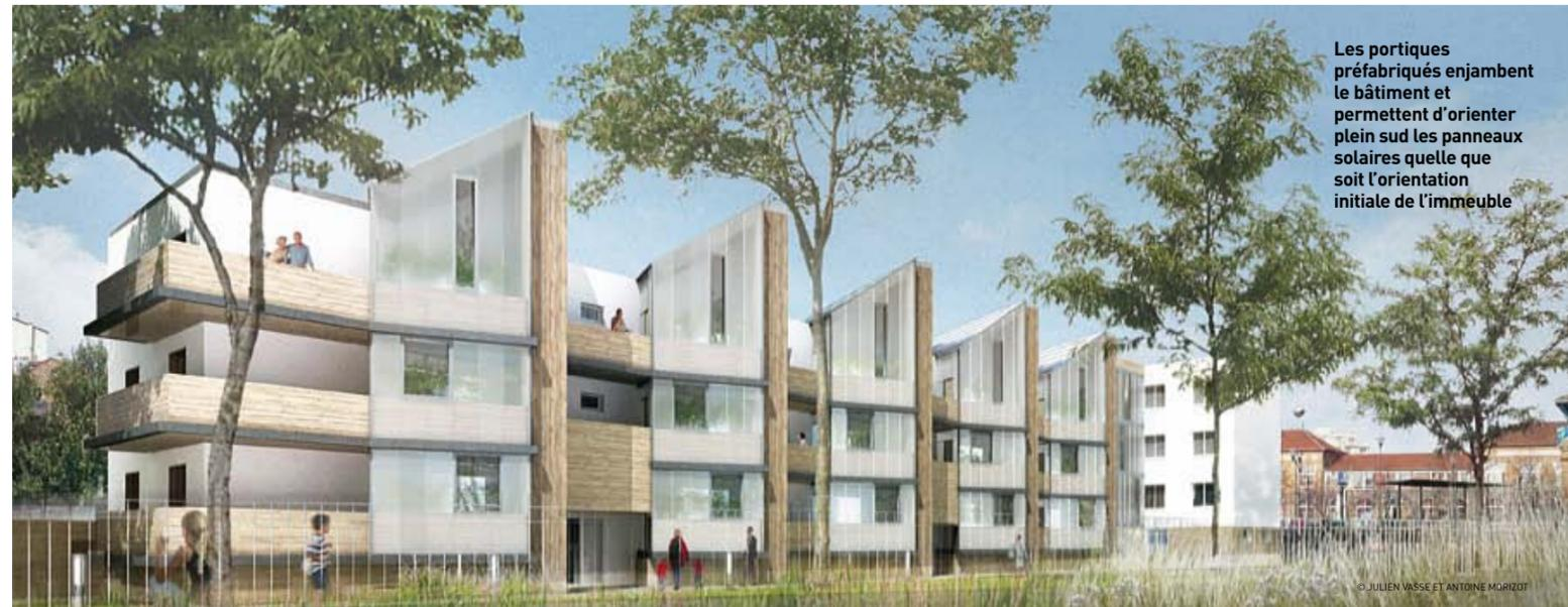
Les portiques préfabriqués enjambent le bâtiment et permettent d'orienter plein sud les panneaux solaires quelle que soit l'orientation initiale de l'immeuble
