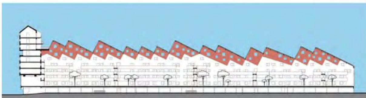
**Ill. 46 Schémas de simulation d'éclairage extraits du dossier de demande de dérogation. Nota : le calcul du facteur de lumière du jour de l'atrium représenté a été effectué avec la configuration des tympan vitrés. Coupe longitudinale figurant la surface de vitrage perdue après l'opacification des tympan.**
