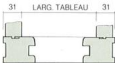
DÉTAIL DE POSE DES TABLEAUX SUR FENÊTRES
