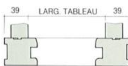
DÉTAIL DE POSE DES TABLEAUX SUR PORTES-FENÊTRES A 2 VANTAUX
