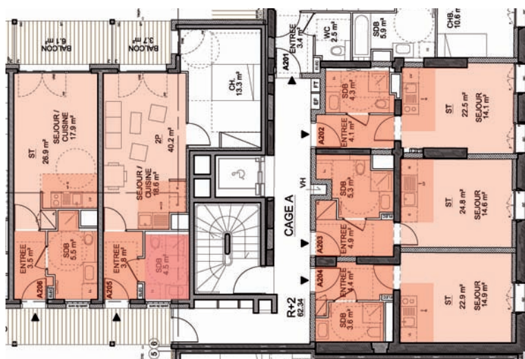
Exemples de studios et d'un 2 pièces au R+2 de la cage A, les logements desservis par le palier sont réhabilités
