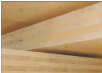
La Matière première pour la production provient des planches de dosse des épicéas indigènes. Pour la fabrication des panneaux contrecollés KLH, seul du bois séché artificiellement avec une humidité de 12 % ( +/- 2%) est utilisé. L'attaque d'insectes ou de champignons est ainsi exclu.
