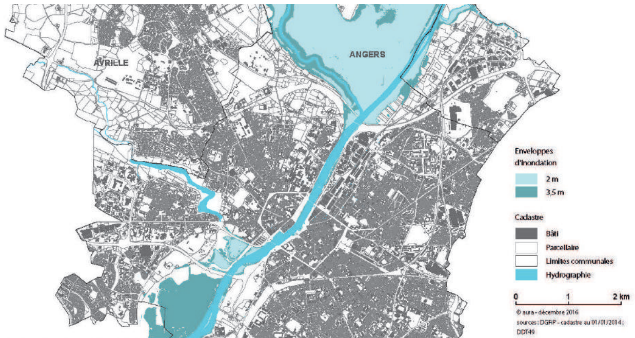
Enveloppe d'inondation des crues fréquentes
