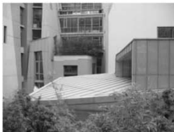
Une soute à solvant avec périmètre de sécurité et un toit libéré pour pouvoir exploser par le dessus
