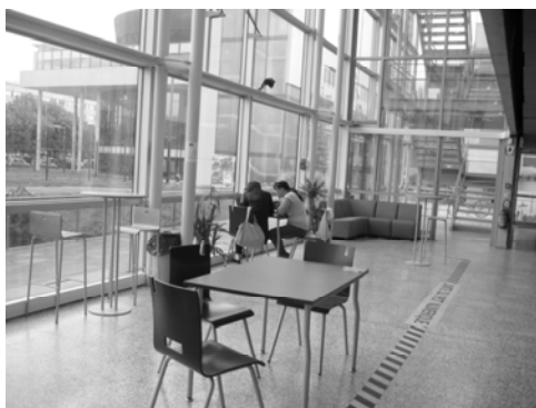
Marquage jaune au sol pour préserver l'espace de circulation réglementaire
