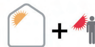
Chauffage habitat diffus et chauffage ponctuel dissocié
