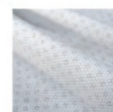
Textile avec micro capsules à changement de phase (PCM) capables d'absorber, d'emmagasiner et de restituer la chaleur.
