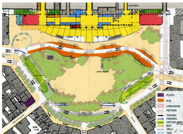
Figure 27 : Nouvelle place de la gare, connexion à la gare et inscriptions dans les flux 87
