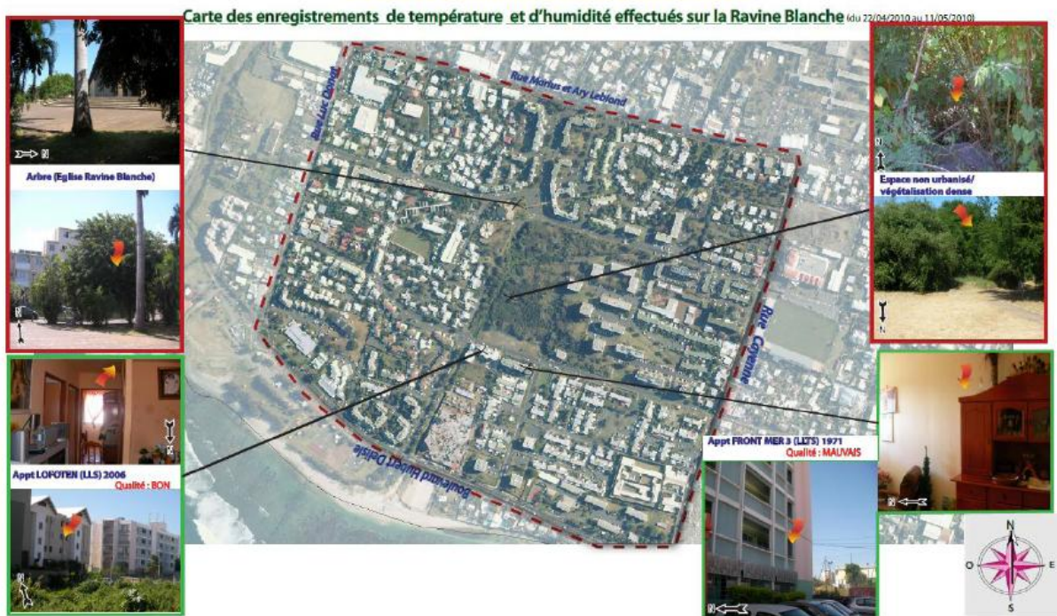
Figure 22: Seconde campagne des mesures (avril 2010). Localisation des capteurs de température et d'humidité
