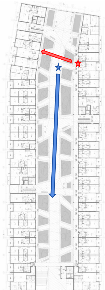
Localisation des mesures de décroissance sonore spatiale dans l'atrium. En bleu, la décroissance suivant la longueur de l'atrium et en rouge la décroissance suivant la largeur
