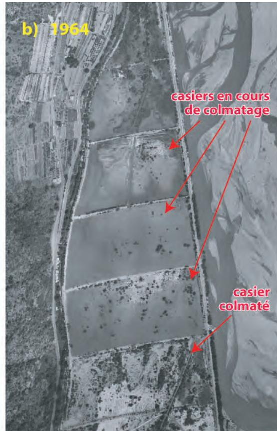
Figure 3. Exemples de casiers en rive droite à différents stades de colmatage (1948 et 1964)
