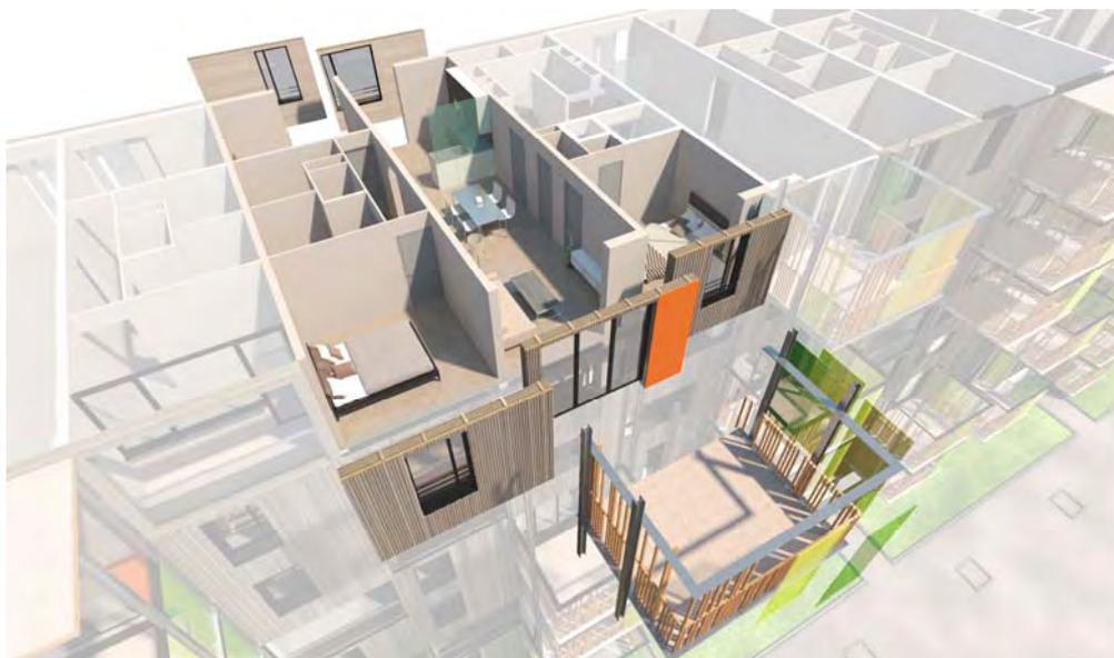
Une approche globale qui inclut un système de préfabrication permettant une intervention initiale sur l'enveloppe, puis des interventions ponctuelles au fil du temps
