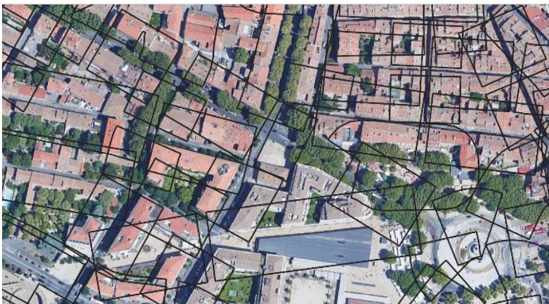
Analyse par graphe du réseau viaire d'Aix-en-Provence faisant ressortir ses segments les plus centraux.
