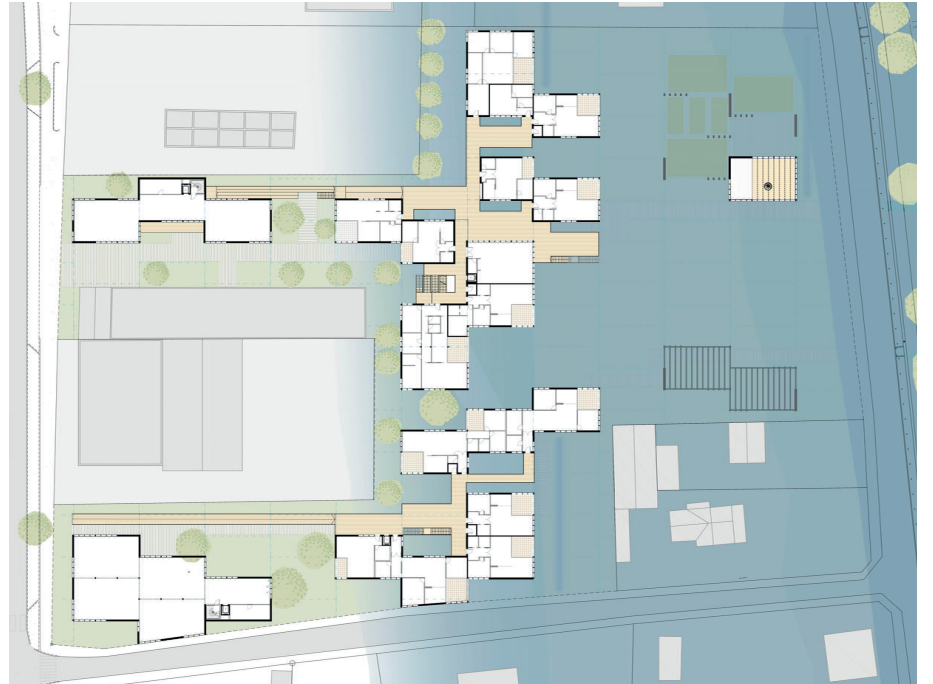
Plan du R+1. Distribution d'un des groupements de logements et d'espaces communs. Plan en temps de crue. E 1/200
