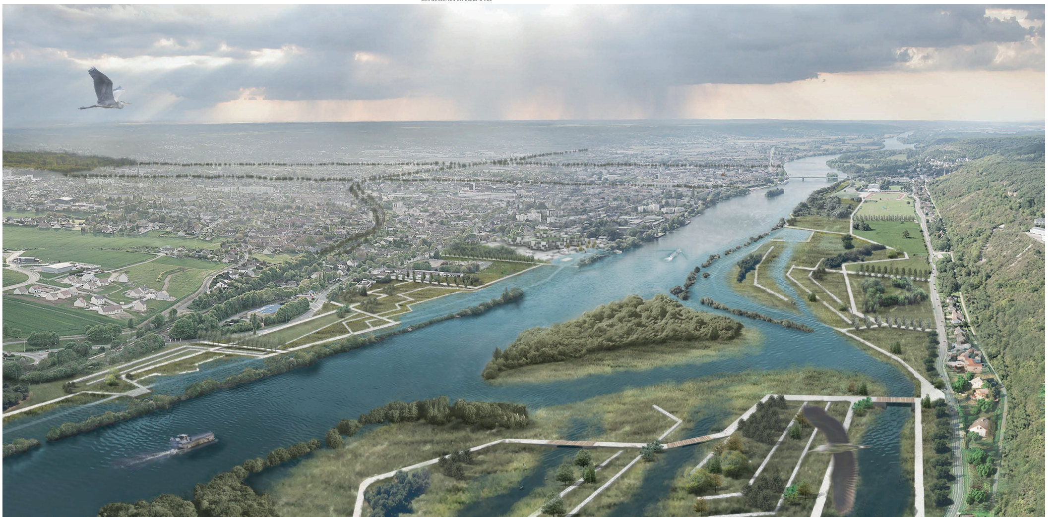
Vue d'oiseau avec les aménagements paysagers réalisés sur les deux rives, pour étaler au mieux le débit de la Seine dans l'objectif d'atténuer les impacts de la crue sur le cœur de la ville de Vernon
