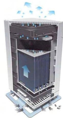
> « Purificateur d'air. Il est équipé d'un préfiltre lavable, d'un filtre à particules avec champs magnétiques et d'un filtre à charbons actifs. » Puremaison.fr
