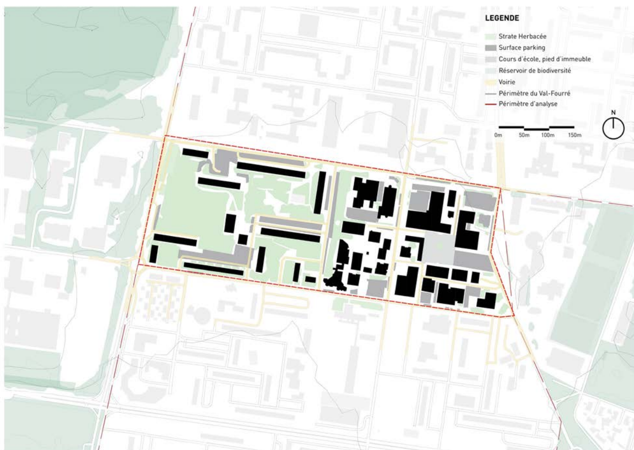
Fig.16. Plan des espaces imperméabilisés et végétalisés Source : Corine Land Cover, données régionales ( IDF, Normandie, Centre Val de Loire), IPR, MOS et relevés de terrain
