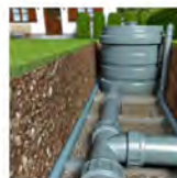
Bassin de rétention enterré étanche
