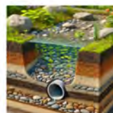
Système de biorétention infiltrant drainé
