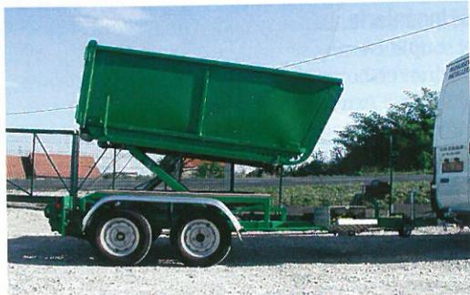
au secteur du BTP, des espaces verts qu'à celui des loisirs ou encore des collectivités... Tous les accessoires sont amovibles et interchangeables. Ils sont équipés de rails avec galets de roulement pour pouvoir rouler au sol et glisser sur le châssis au moment du chargement ou du déchargement qui s'effectue par treuils électriques ou hydrauliques et poulies de renvoi. Des bras compas multi-
