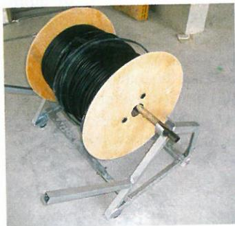
peut charger un touret en un tour de main: plus besoin de soulever le touret qui reste à terre, l'axe central amovible est simplement passé dans la bobine; grâce à deux leviers de préhension situés à l'arrière, la dérouleuse est ensuite basculée vers l'avant pour venir emboîter l'axe central puis l'ensemble est rebasculé en position droite. Simple, facile et rapide. D'ailleurs, tout a été
