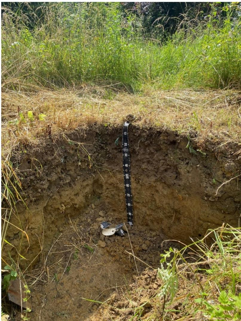
La photo ci-contre montre une fosse pédologique d'un mètre de profondeur, réalisée par le bureau d'études Sol Paysage dans les jardins familiaux de Ris-Orangis. On y distingue assez clairement quatre couches de sol grâce à leur couleur. Le prélèvement d'échantillons dans chacune des couches permettait également de comparer les caractéristiques physiques de chaque couche de sol.
