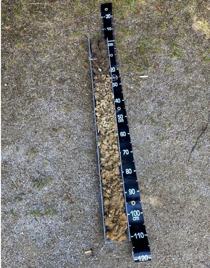
Ce sondage à la tarière manuelle permet de relever les différentes couches qui composent le sol et d'en observer les caractéristiques.
