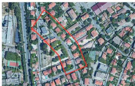
Fig. 1. Exemple de découpage d'une portion du réseau viaire aixois en un ensemble de tronçons.
