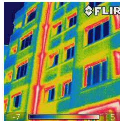
déperditions importantes aux murs non isolés, au décrochés de façade et aux cadres des fenêtres non remplacés.
